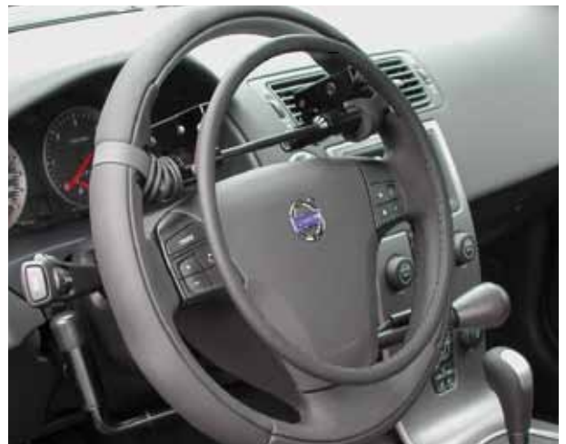
Je nach den Bedürfnissen des Fahrers, wird links oder rechts neben dem Lenkrad eine Stossbremse montiert.
